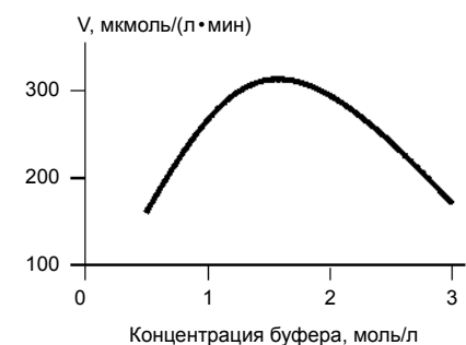
Рис. 8. Зависимость скорости гидролиза p-NPP щелочной фосфатазой от концентрации диэтаноломинового буфера.
